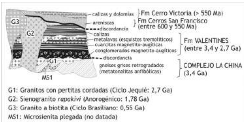
Figura 10 – Estratigrafía conceptual del Bloque Taquarembó–Valentines.
